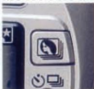
Die Motiv-Programmwahl erlaubt die Anpassung der Belichtungsautomatik an die Gegebenheiten eines Motivs. Es stehen fünf Motivprogramme, die einfach über ein Symbol anzuwählen
