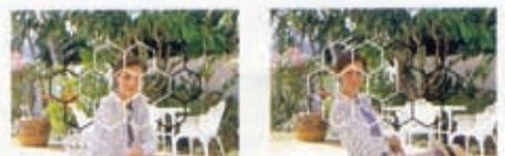
**Die 14-Segment-Wabenfelder-Mehrzonennmessung** berechnet die unterschiedlichsten Lichtsituationen durch motivbezogene Auswahl der 14 Segmente.
