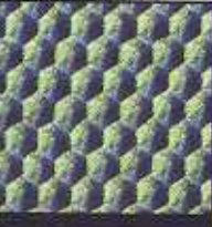
Mikrowaben-Einstellscheibe (2000 bis 20000x vergrößert)
