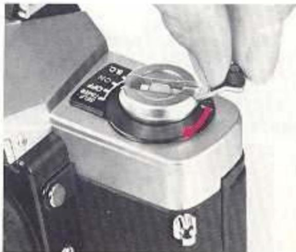
3. Wenn Sie sicher sind, daß der Film ganz zurückgespult ist, Rückwandentsperrknopf herausziehen, (bis die Rückwand aufspringt) und den belichteten Film herausnehmen.
