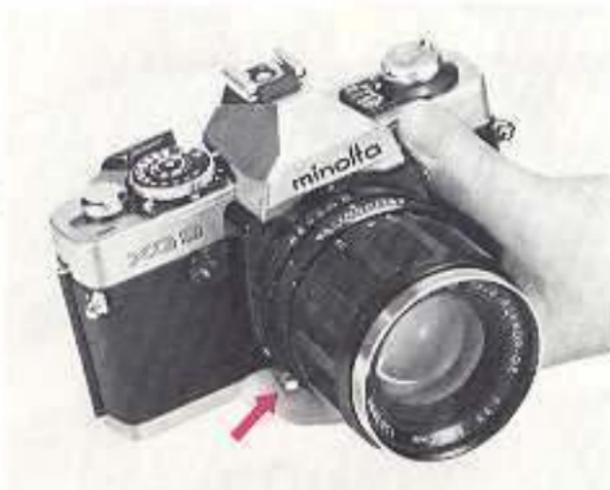
2. Wenn das Einstellrad für Verschlusszeit und Funktion auf „A“ steht, wählen Sie eine Blende, wie auf den Seiten 24 bis 25 beschrieben. Das Sucherfeld wird durch die Abblendung dunkler, und möglicherweise sind Schnittbildindikator und Mikropriemenring nicht mehr verwendbar.
