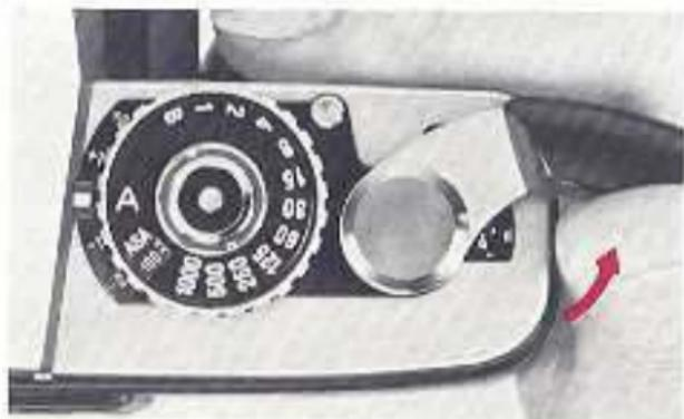
Stoppt der Transporthebel am Filmente und widersteht er weiteren Bewegungen, so versuchen Sie niemals, mit Gewalt weiterzutransportieren. (Siehe S. 41: Filmrückspulung und Entladen der Kamera.) Beim Öffnen der Kamerarückwand schnellst das Bildzählwerk automatisch auf „S“ zurück.
