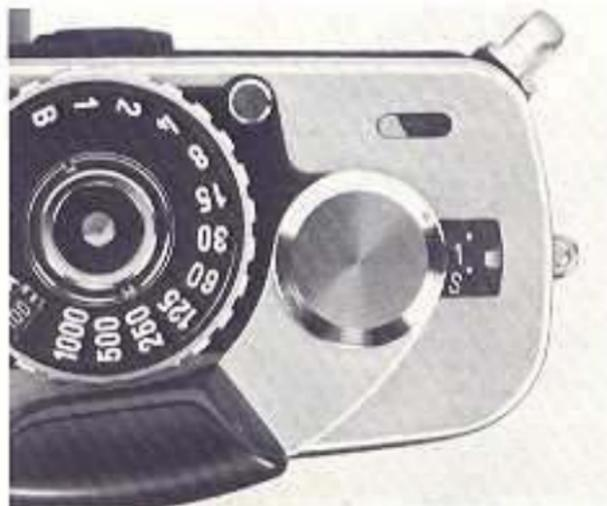
7. Im Fenster der Filmladekontrolle sollte jetzt links ein roter Balken erscheinen, der anzeigt, daß der Film eingelegt ist und sich richtig auf die Aufwickelspule wickelt. Erscheint dieses Signal nicht oder weit rechts im Fenster, wiederholen Sie die Schritte 1. bis 6., um sicherzugehen, daß der Film richtig transportiert wird. Während der Aufnahmen wandert der rote Balken im Fenster allmählich nach rechts und zeigt dadurch korrekten Filmtransport an.
