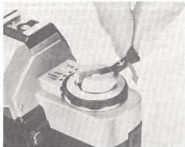
3. Wenn Sie sicher sind, daß der Film komplett zurückgespult ist, Rückwand-Entriegelungsknopf herausziehen, bis die Rückwand aufspringt. Den belichteten Film herausnehmen.
