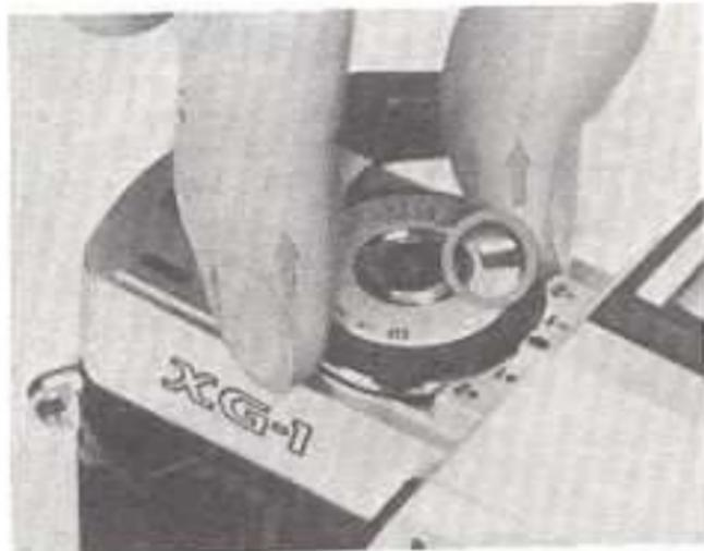
drehen läßt. Steht der richtige ASA-Wert in der Filmempfindlichkeitsanzeige, lassen Sie den Ring in dieser Position einrasten. Die Markierungen zwischen den ASA-Werten bedeuten:
