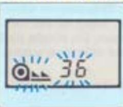
2. Zum Starten des Rückspulmotors bei gedrückter Rückspulentsperrung (R) den Rückspulschalter nach links ziehen. Ein Film mit 24 Bildern ist in etwa 16 s zurückgespult.
