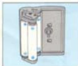
2. Vier Micro-Batterien (AAA) Alkali-Mangan einsetzen, wobei die Pole + und - so liegen müssen, wie im Halter markiert. Batteriefach wieder an Kamera anbringen.
