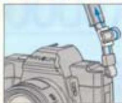
Okulardeckel auf den Trageriemen schieben und den Riemen wie gezeigt an der Kamera befestigen. Der Okulardeckel kann zum Abdecken des Sucherokulars bei Selbstauslöseraufnahmen benutzt werden.
